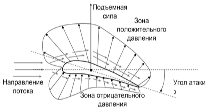
Рис.1. Принцип подъемной силы R на примере аэродинамического профиля
